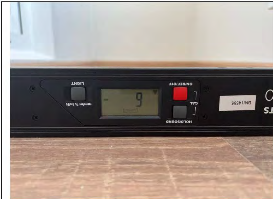
Фото №31. Измерение уровня напольного покрытия в лодгии.
