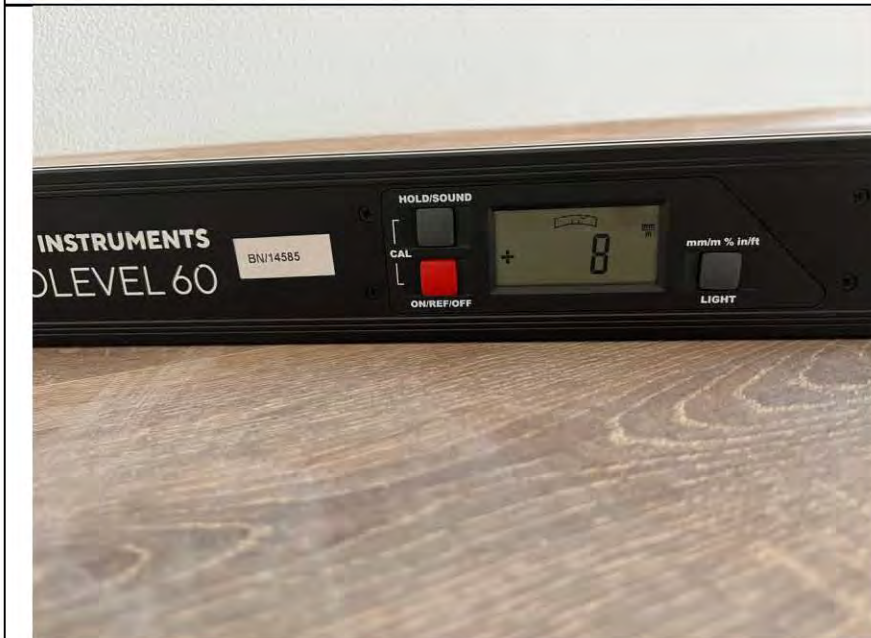
Фото №29. Измерение уровня напольного покрытия в спальне.
